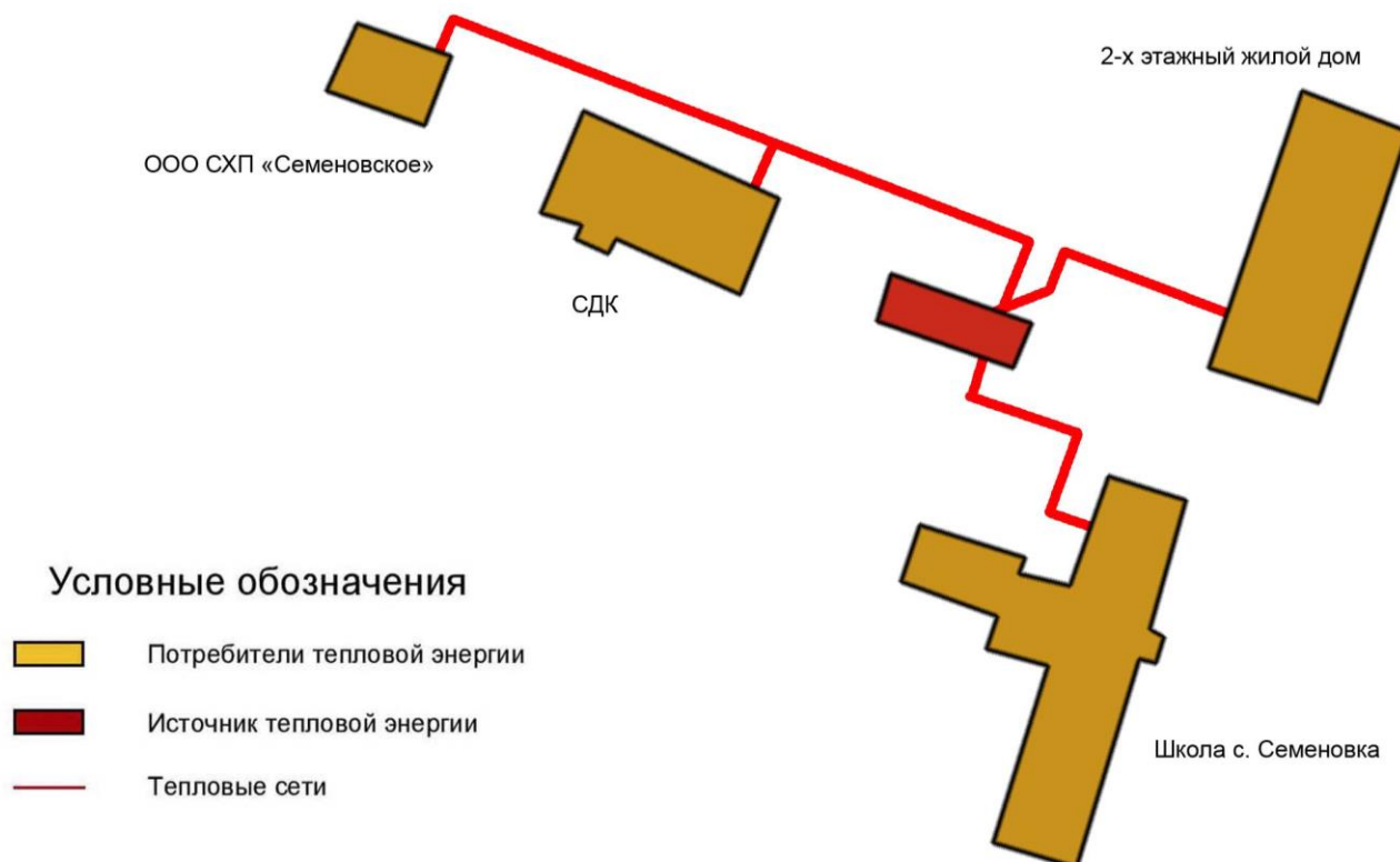
Рисунок 1.7. Графическое изображение тепловой сети центральной модульной котельной с. Семеновка.
